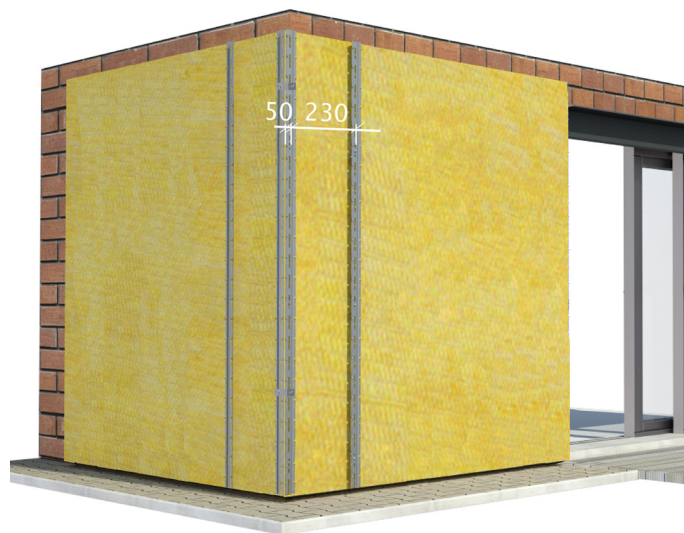
Obr.22- osová vzdálenost svislých Omega lišt od nároží
