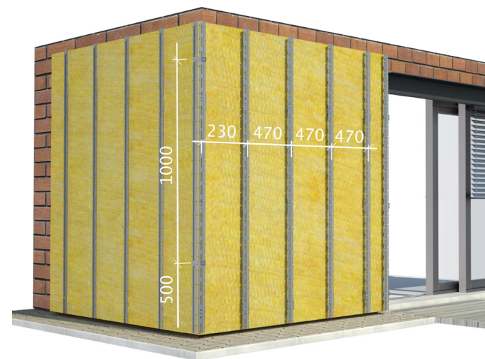
Obr.23- uchycení svislých Omega lišt
