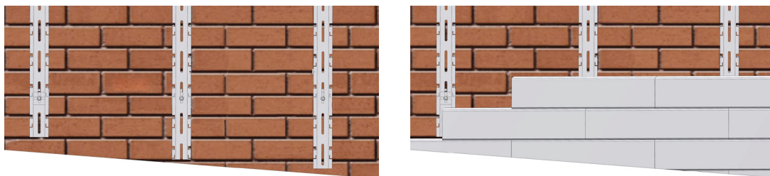
Obr.29- založení křížového roštu nad příkrým terénem
