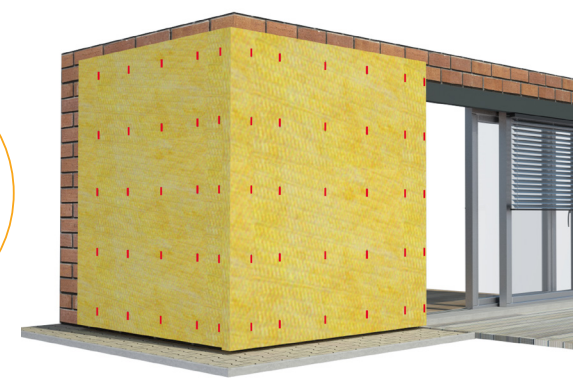
Obr.12- minerální tepelná izolace nasunutá na připevněná vzpěrná ramena
