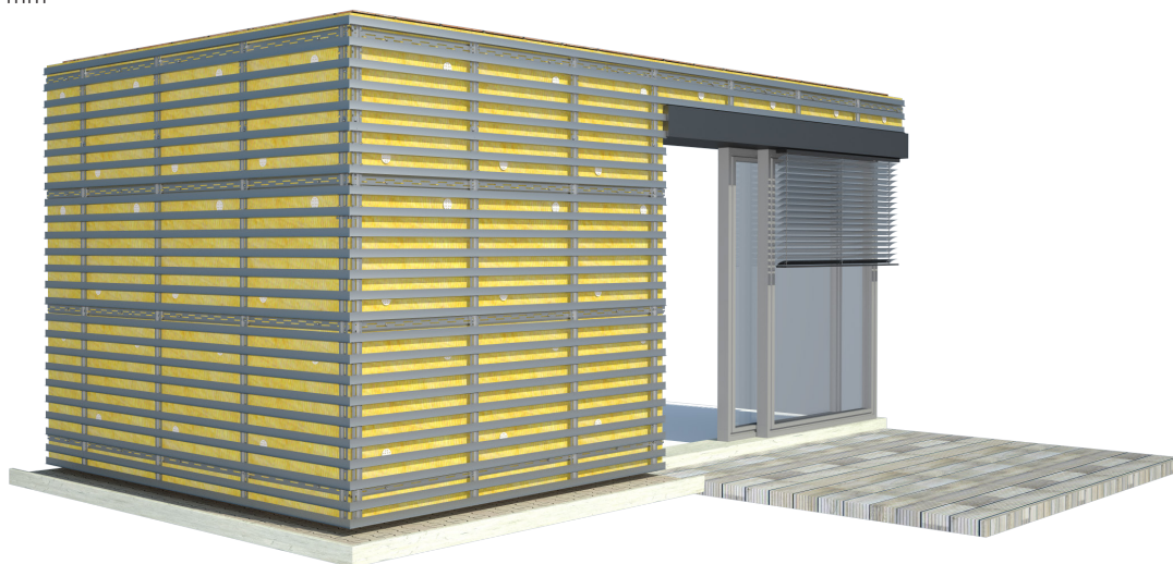
Obr.33- nosný kovový rošt s tepelnou izolací připraven k obložení fasádními cihlami
