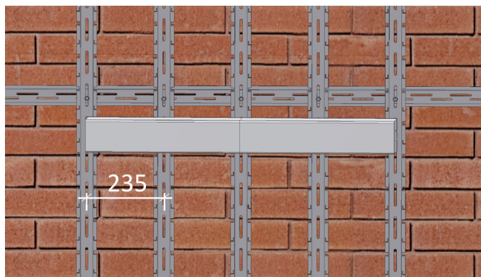
Obr.54- b/ zhuštěný křížový rošt
