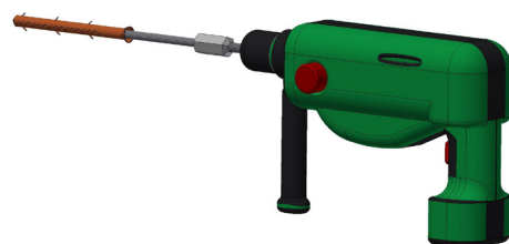
Obr.4- použití bitu k utažení závitové tyče
