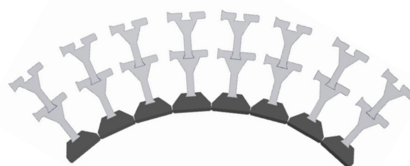
Obr. 7.1.1c Příklad vyduté opěrné zdi s větším poloměrem
